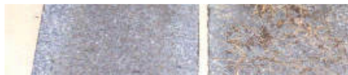
Papy IZOLMAT PLAN zielony dach nie ulegają penetracji i nie noszą znaków obecności roślin w przeciwieństwie do zwykłych pap.
