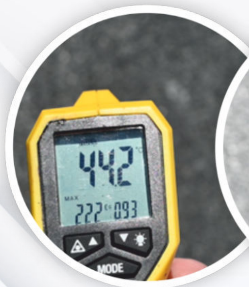
temperatura dachu przed malowaniem
